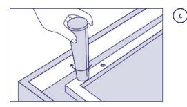
Retirez le ruban adhésif vert et vissez à la main les six pieds aux positions indiquées sur le cadre métallique, sauf si vous l'utilisez sur une base à lattes. Ne serrez PAS trop fort. À l'aide des sangles velcro, fixez les capteurs de lumière à chaque pied du milieu.
